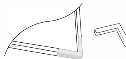
3) 在托盘上放上纸衬板, 然后将组件垂直放在纸衬板上, 有护角和无护角的组件间隔摆放, 最外侧两块组件玻璃面朝外放置。
